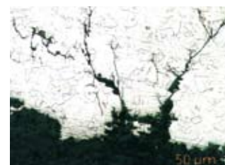
Příklad trhliny způsobené transkrystalickou korozi napětím v plechu 1.4401, který byl vystaven značně velkým účinkům chlóru.
